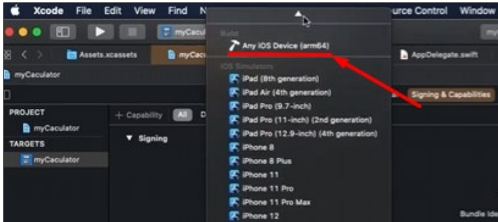
รูปที่ 165 หน้าจอโปรแกรม Xcode เลือก Device สำหรับ Any iOS Device
